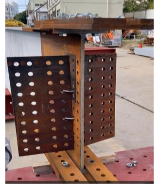
2. 通した丁番アシスト本体にプレートを取り付ける
